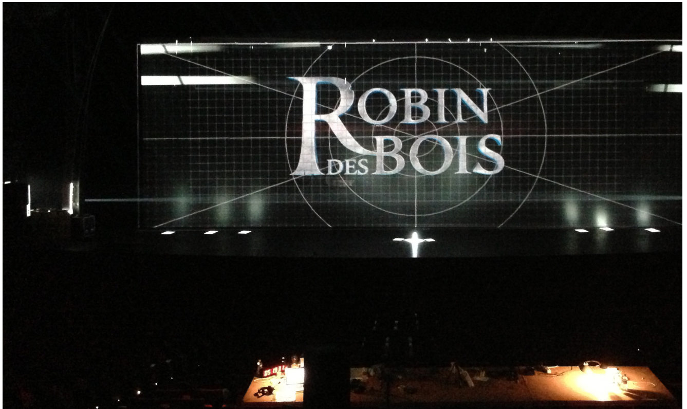
Fig 56: Les lignes et cercles autour l'image projetée sont un moyen pour calibrer les surfaces en distorsion. Ici à l'aide du Modulo pi, au Palais de Congrès, avec le preset de la mire.
