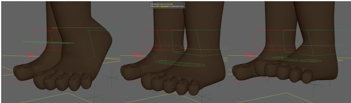
*Reverse foot : au centre pied posé à plat, à gauche pivot sur l'orteil, à droite pivot sur le talon*
